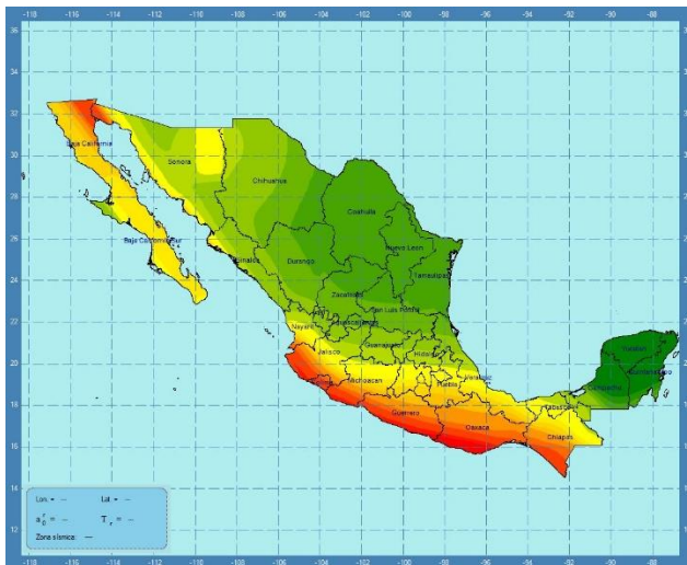
Ilustración 52.- Macrolocalización Sísmica CFE-2015
