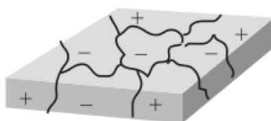
Figura 1.- Zonas catódicas y anódicas de una aleación.
