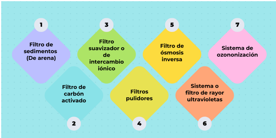
Figura 2. Etapas de proceso para la purificación de agua
