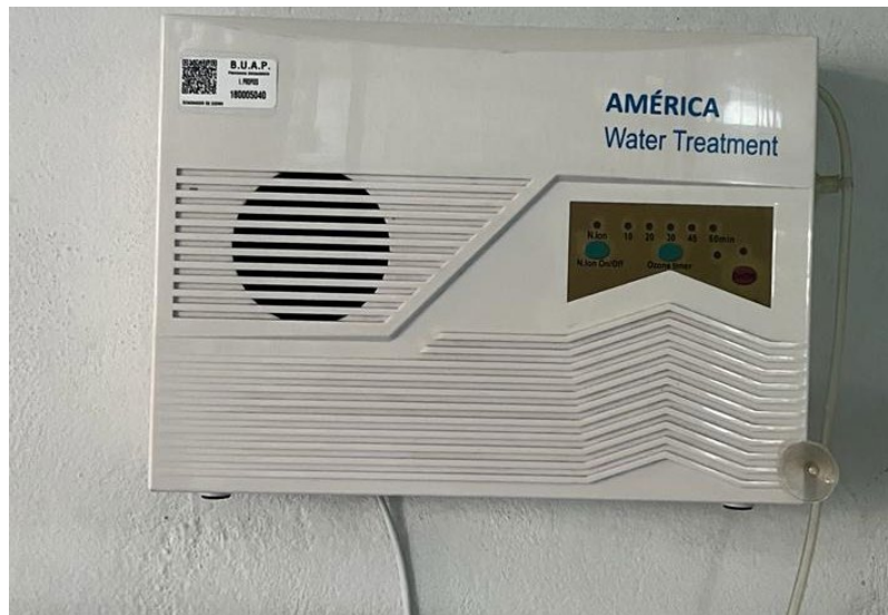
Figura 2.25. Generador de ozono #2.
