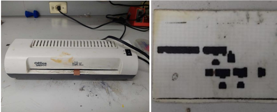
Figura 38 a) Circuito pasando por enmicadora y b) placa después de pasar por enmicadora
