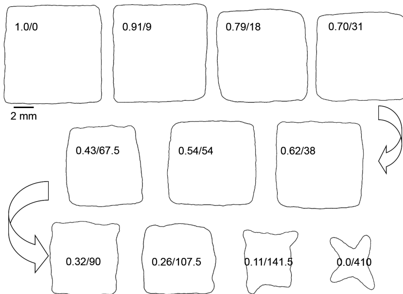
Figura 7.12. Mapa de encogimiento-deformación de los prismas de papa secados a una temperatura de 70°C.
