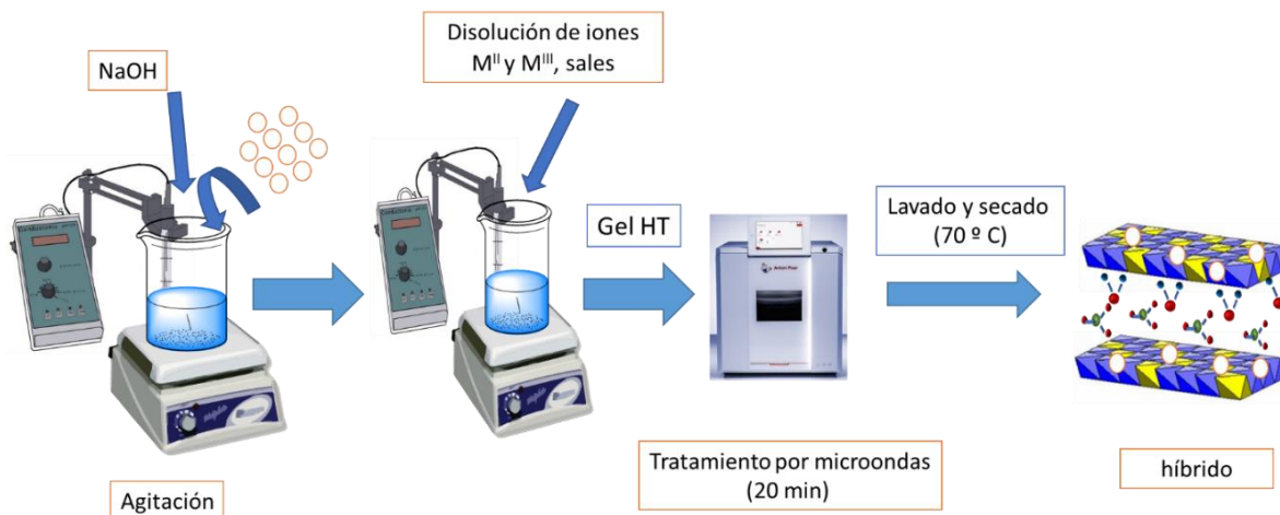
Figura 2.4. Esquema del procedimiento de síntesis de los híbridos vía cristalización con microondas.
