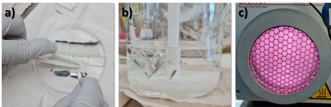
Figura 3.4.1: Imágenes fotográficas del proceso del ataque químico al FTO, lavado y preparación de los sustratos para el ensamble de la celda solar. (a) Ataque químico para remover el FTO usando HCl diluido y polvo de zinc en la zona descubierta del sustrato. (b) Limpieza de los sustratos usando el baño ultrasónico. (c) Los sustratos en limpieza por plasma de oxígeno.
