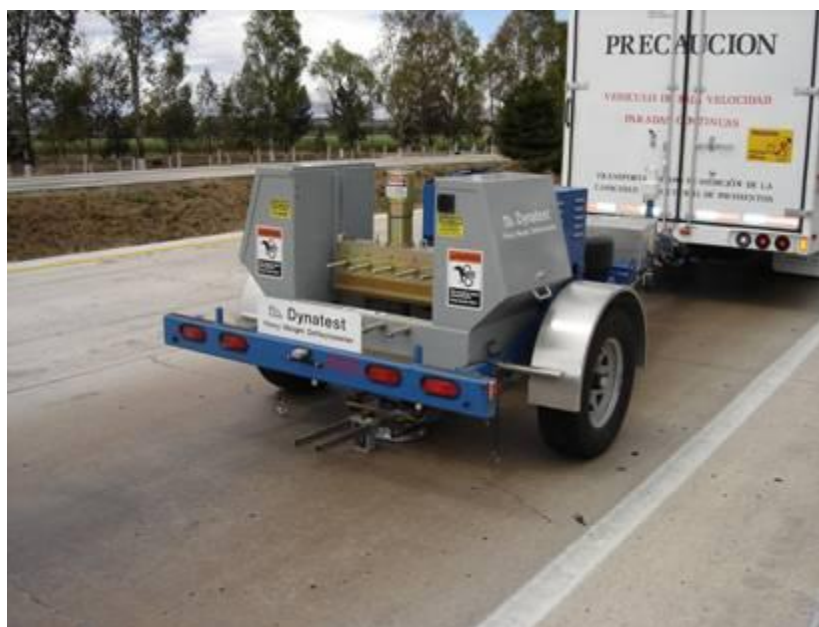
Figura 6. Deflectómetro de Impacto HWD utilizado en la evaluación de carreteras, recuperado de (IMT, 2007)
