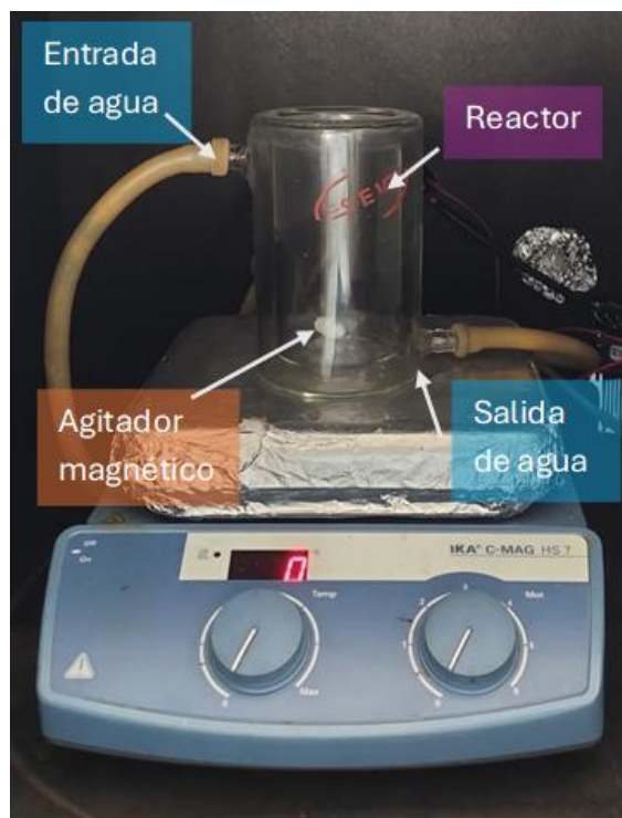
Figura 2.2. Esquema del arreglo experimental de la degradación de azul de metileno. Se observa el reactor conectado a una entrada de agua y una salida de agua, encima de la parrilla agitadora.
