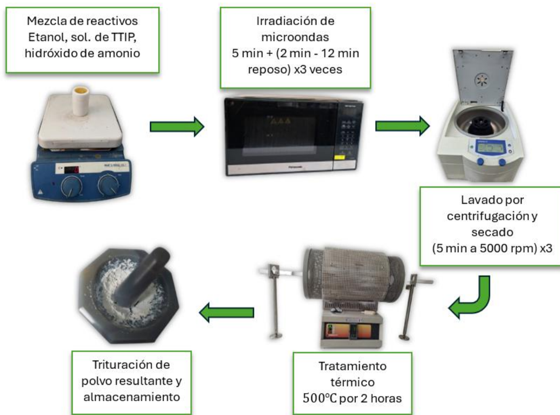
Figura 2.1. Diagrama esquemático de los procesos realizados en la síntesis de nanopartículas \text{TiO}_2 y \text{TiO}_2:\text{Fe} .
