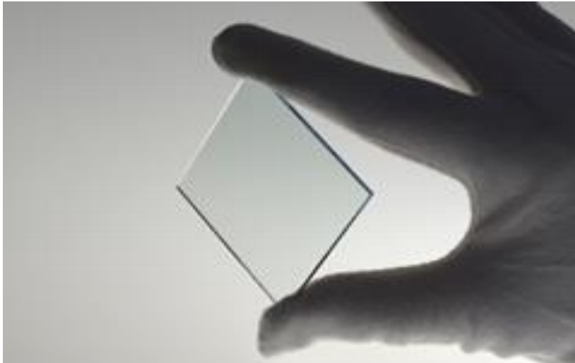
Figura 1.1. ECT hecho a base de un sustrato de vidrio recubierto con ITO.
