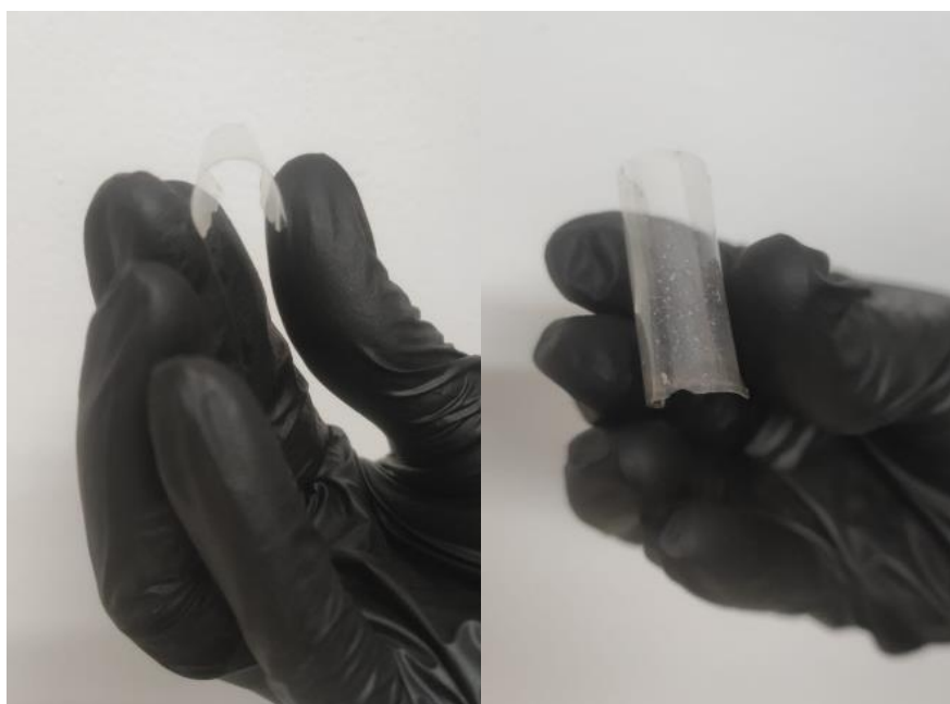
Figura 3.16. Pruebas de flexión realizadas con un ángulo de 85^\circ a la película nanocomposita híbrida (PVA/NAs-Ag/TiO 2 ).
