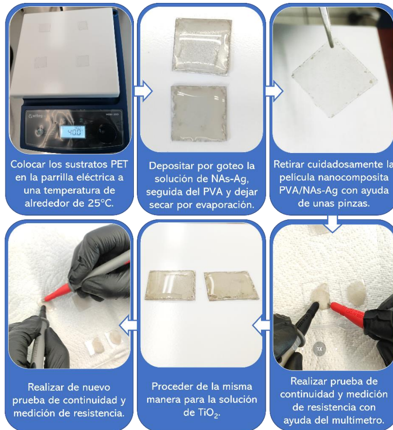
Figura 2.6. Esquema de bloques del proceso de fabricación por drop-casting.
