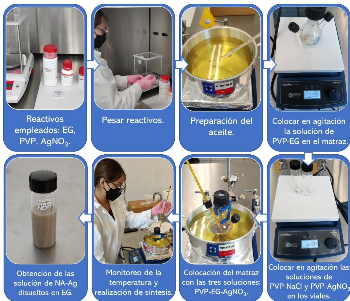
Figura 2.3. Esquema de bloques e imágenes del proceso de síntesis de NAs-Ag.
