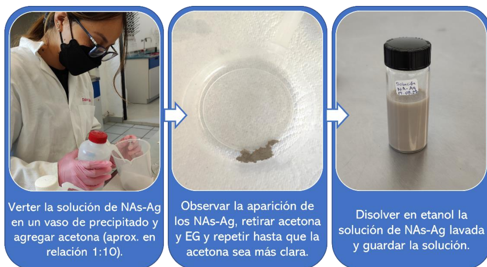
Figura 2.4. Esquema de bloques e imágenes del proceso de lavado de NAs-Ag.
