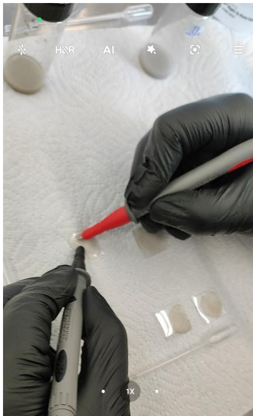
Figura 2.14. Realización de la caracterización eléctrica por el método de dos puntas.
