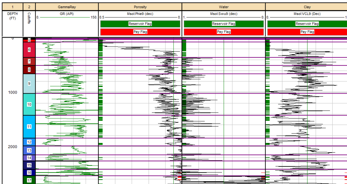
Figura 3.11. Determinación de las zonas de paga. De color verde se muestran las zonas de interés y en color rojo las zonas de paga en el pozo Klaassen No. 1.
