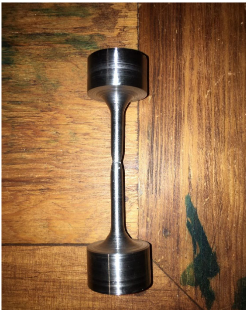
Figura 79 Probeta numero 5 despues del ensayo de tensión.
