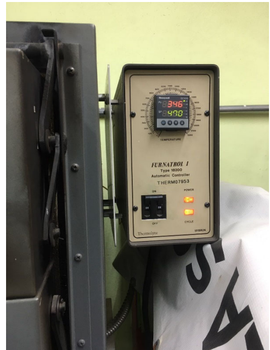
Figura 55 modificación del control de temperatura.
