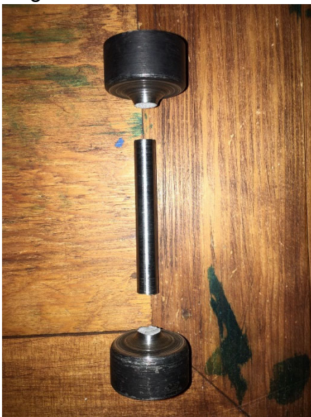
Figura 71 probeta 1 después del ensayo de tensión.
