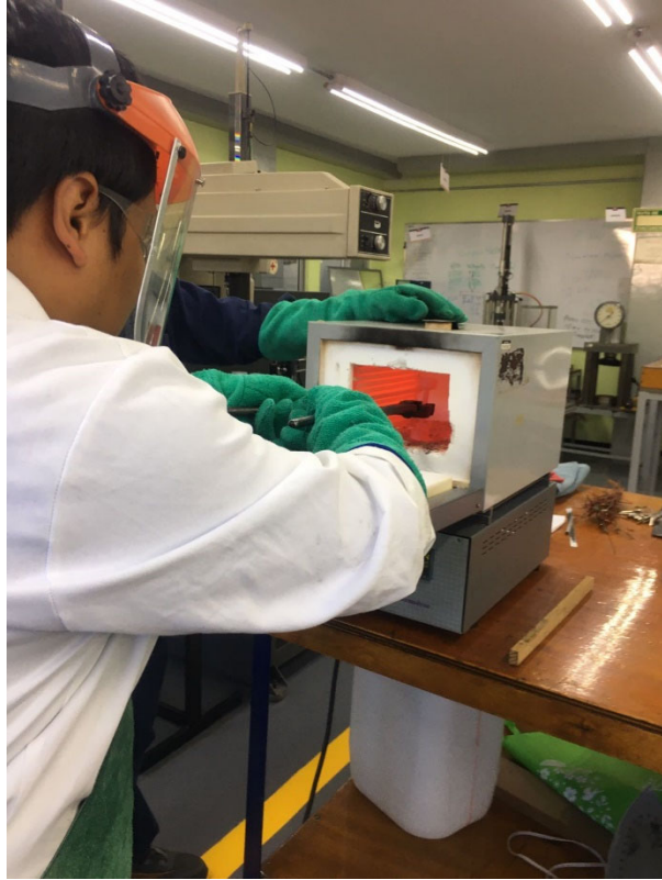
Figura 50 manipulación de probeta 2 para el cambio de horno.
