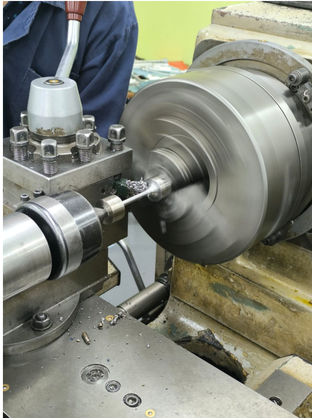
Figura 59 Probeta numero 5 siendo maquinada a 6 milímetros de diámetro.
