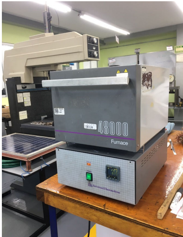
Figura 42 Horno de uso industrial marca thermolyne color blanco.
