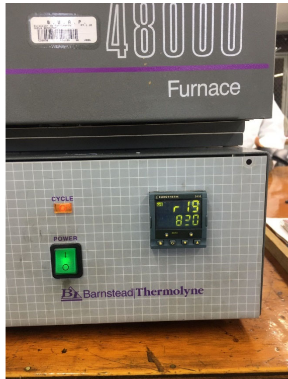
Figura 45 Horno a 819°C programado a 830°C.
