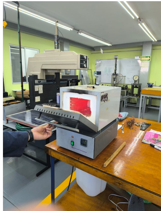
Figura 61 Horno 1 a 790 °C antes de alcanzar los 820°C.
