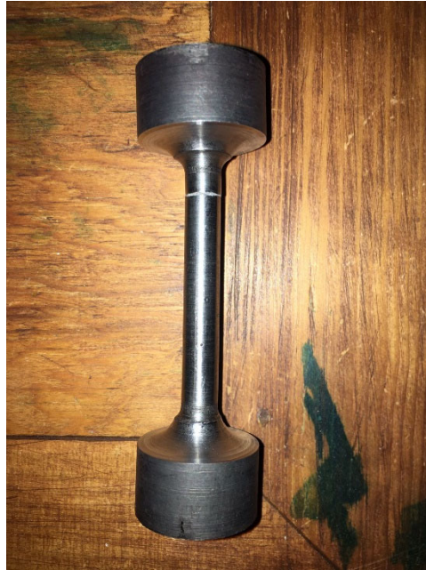
Figura 73 probeta número 2 después del ensayo de tensión.
