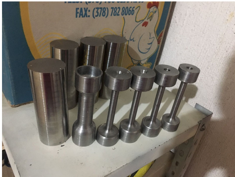
Figura 34 Probetas finalizadas en comparación con el diseño uno y un bruto de acero.
