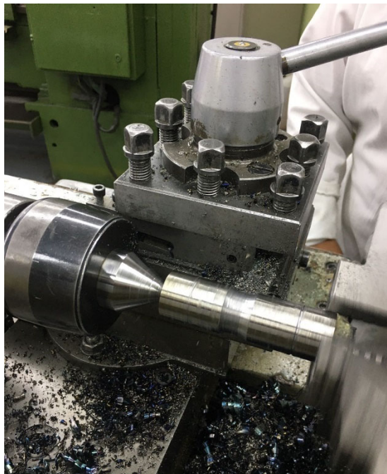
Figura 36 maquinado de la 6ta probeta.
