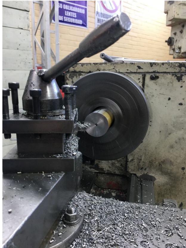
Figura 26 careado de las piezas de metal.
