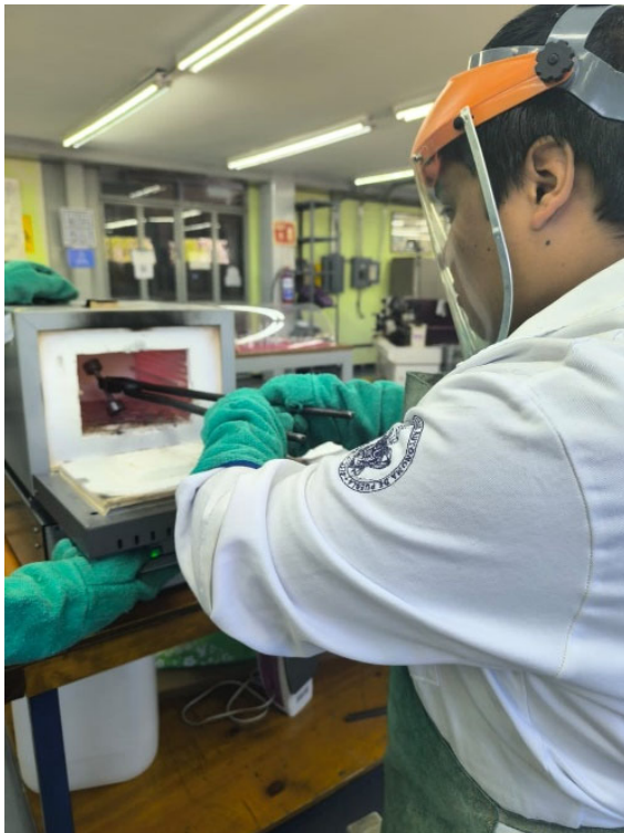
Figura 44 Colocación de la probeta dentro del horno.
