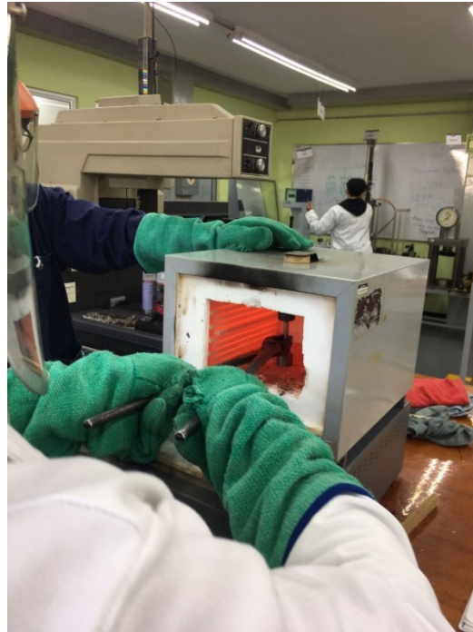
Figura 53 Colocación de probeta número 3 en horno 1.
