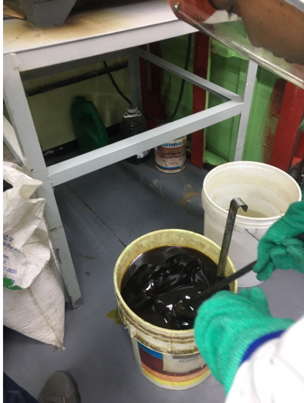
Figura 51 templado de probeta número 2 en aceite.
