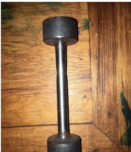
Figura 77 Probeta número 4 después del ensayo de tensión.
