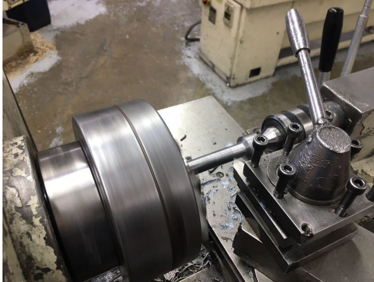
Figura 30 Desbaste Interior de la pieza.
