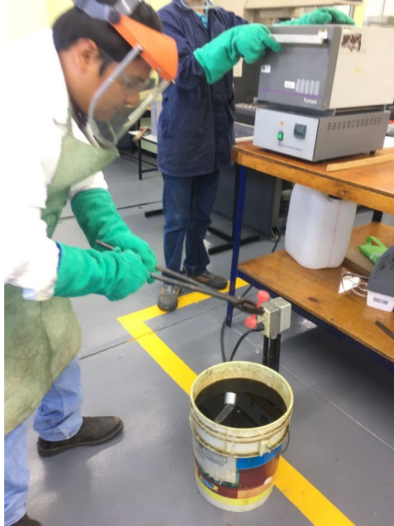
Figura 46 probeta 1 justo antes de ser templada.
