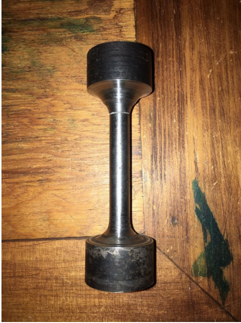
Figura 81 Probeta numero 6 después del ensayo de tensión.
