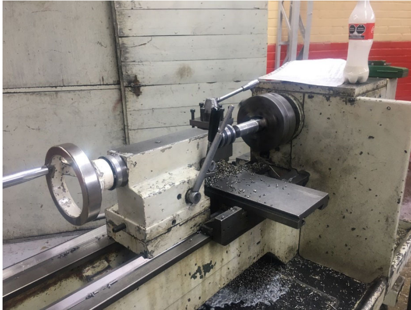
Figura 28 Desbaste de las piezas para el diámetro de 30 mm.
