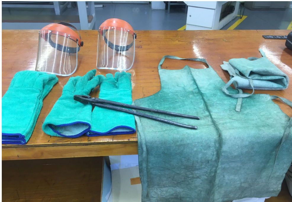
Figura 41 Equipo de seguridad para altas temperaturas.
