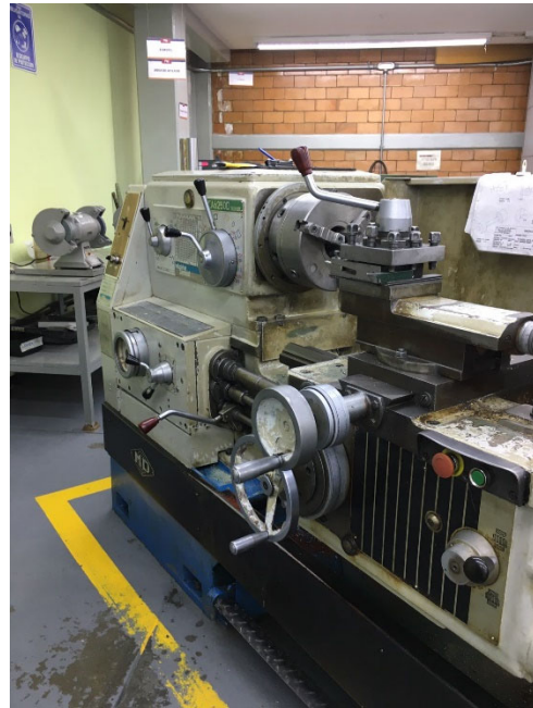
Figura 38 Torno usado en el maquinado, marca Cornmetal.
