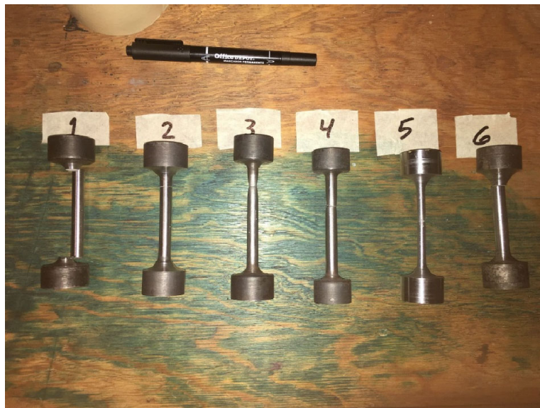
Figura 82 Probetas despues del ensayo de tension.
