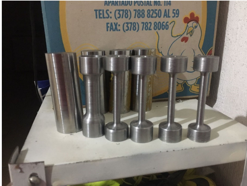
Figura 33 probetas finalizadas junto a otros brutos de acero 4140.
