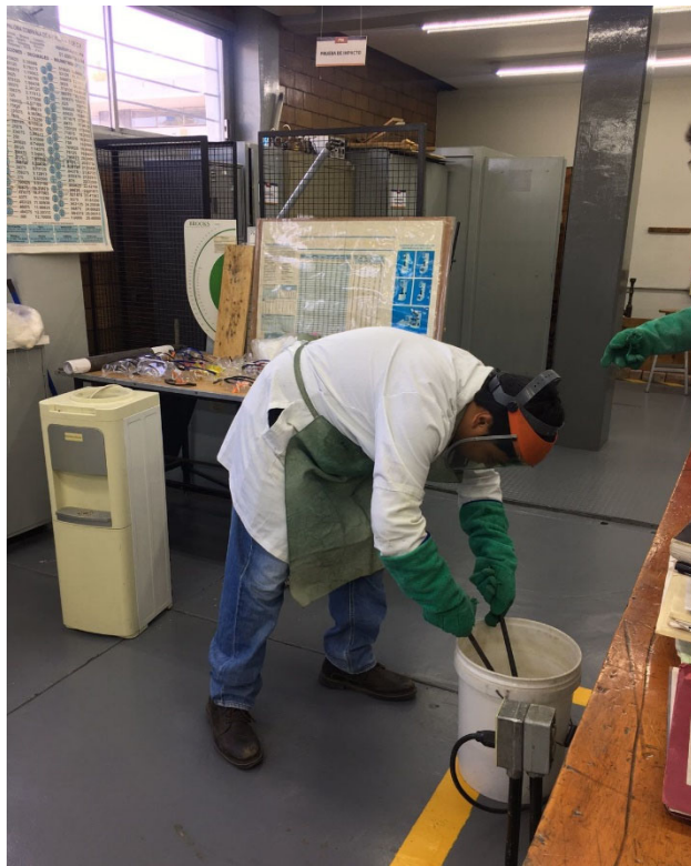
Figura 63 temple en agua de la probeta 6.
