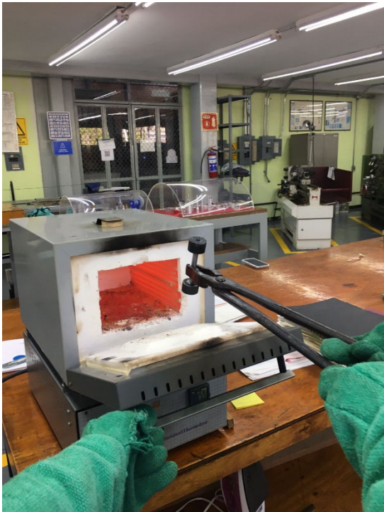
Figura 60 introducción de la probeta número 6 a horno 1.
