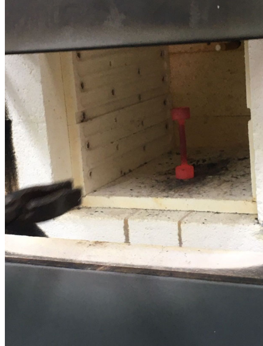
Figura 57 Colocación de la probeta dentro del horno 2.
