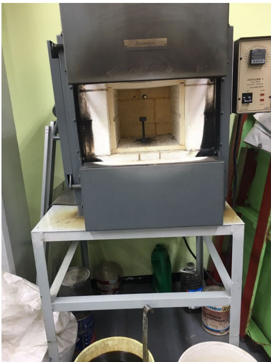
Figura 58 horno abierto para el enfriamiento de la probeta.
