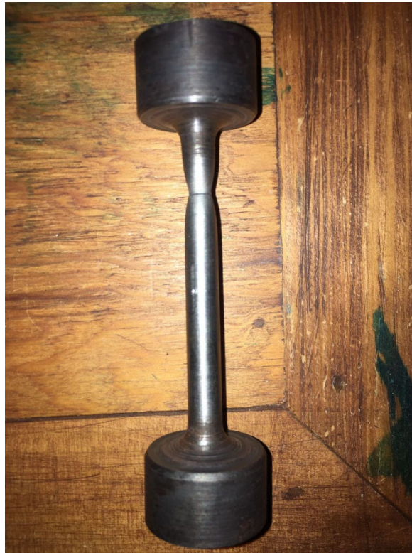
Figura 75 Probeta número 3 después del ensayo de tensión.
