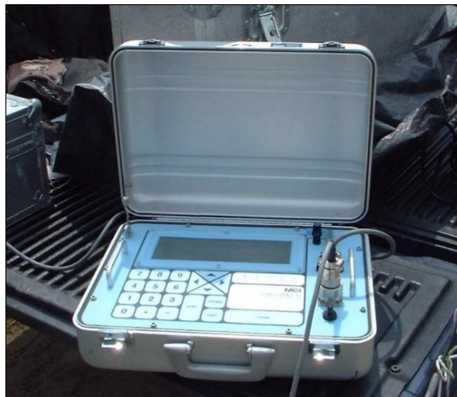
Figura 4.1: Equipo SIROTEM modelo Mark III. Fuente: Bitácora de campo (2017).
