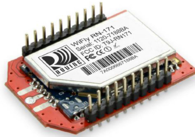
Figura 2.31 Fotografía del módulo RN-XV.
