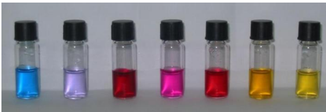
Figura 1.4 Variación de la coloración de nanopartículas de oro en soluciones coloidales por diferente tamaño de partícula [38].
