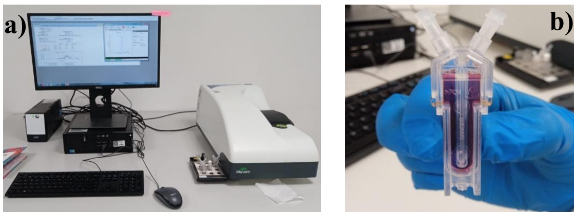
Figura 2.6 Equipo DLS para a) distribución y tamaño de partícula, b) medición del PZ.
