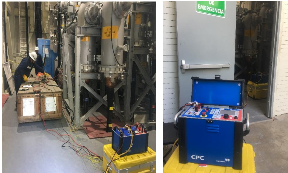
Figura 4.17 Pruebas en campo de medición de impedancia de línea de CDS-93H60-TYA.
