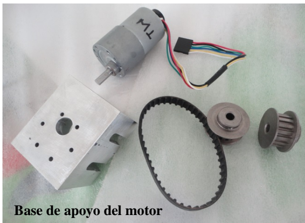
Figura 3.9. a) Sistema de transmisión, b) Montado del motor.
