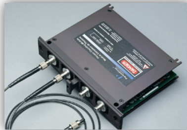
Figura 2.16. Fotodiodo de avalancha utilizado en los experimentos.
