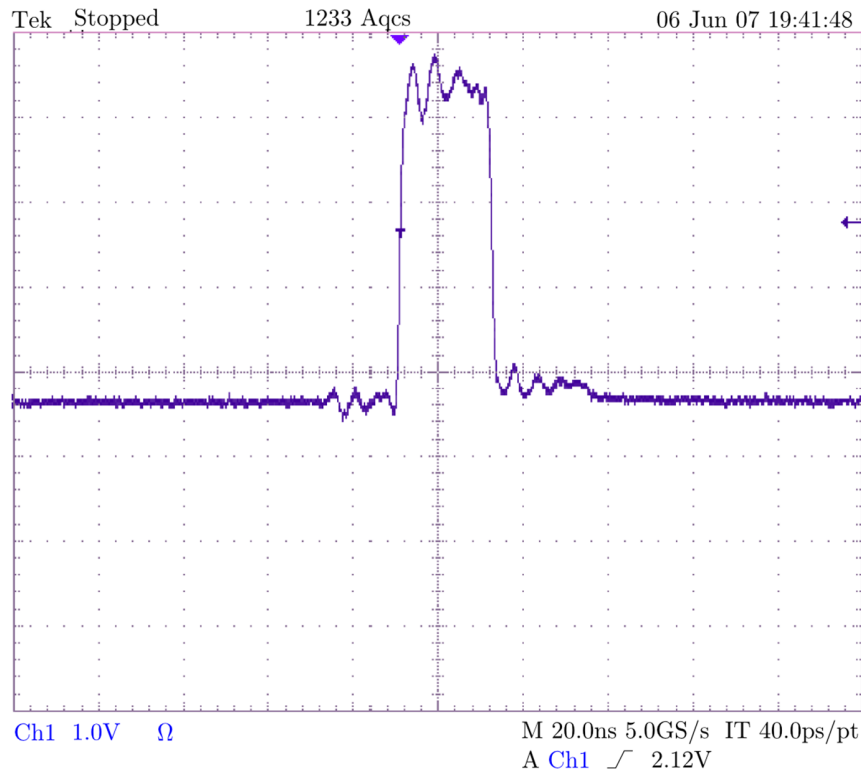
Figura 2.15. Señal producida por el sensor SPCM-AQ-4C.
