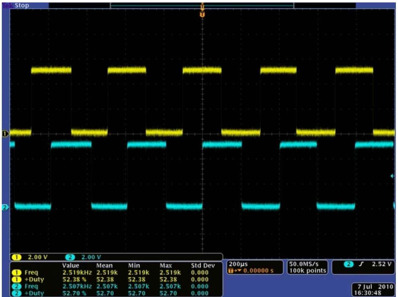
Figura 4.28. Encoder A y B con 64 RCP (motor funcionando a 12 V y 5V encoder).
