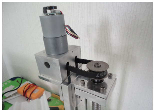
Figura 3.9. a) Sistema de transmisión, b) Montado del motor.
