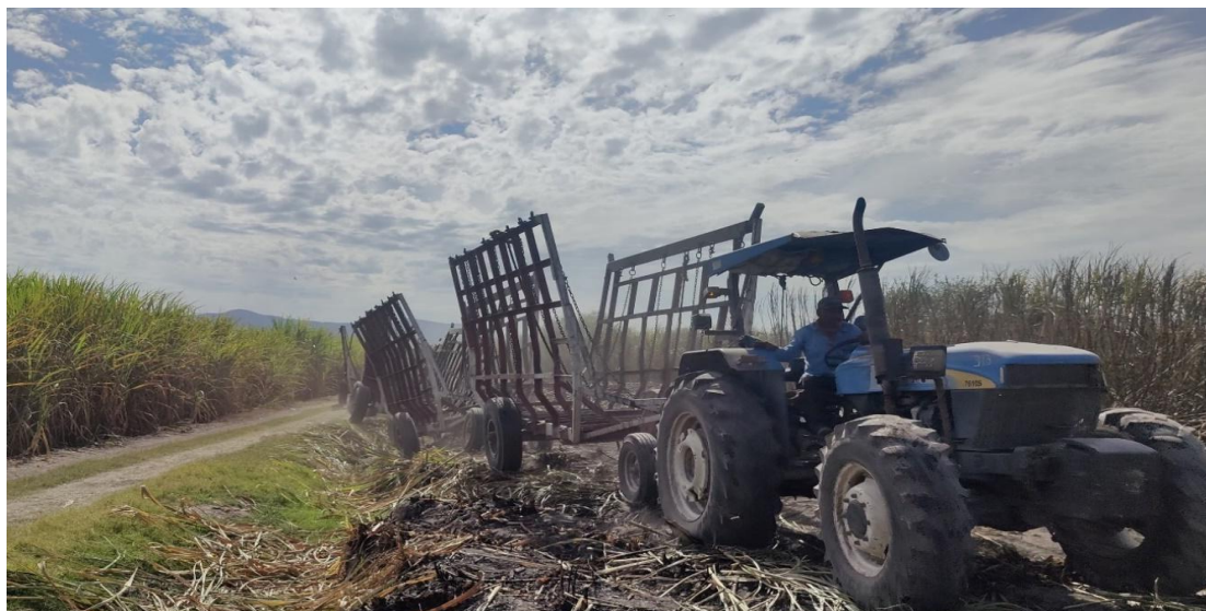
Ilustración 33 Autor: Juan Carlos Rosas, 21/01/2024. Además del uso de camiones Torton, también son empleados remolques guiados por tractores para recolectar y transportar la caña de azúcar hasta el ingenio.
