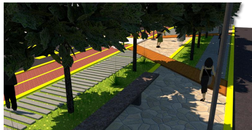
Figura 57. Se observa los 2 diferentes tipos de diseño en los cuales se dividirá el parque, donde uno es de bloques de concreto sobre pasto con una ligera separación y otro es de pavimento con mosaico de piedra. Fuente: Autoría propia.
