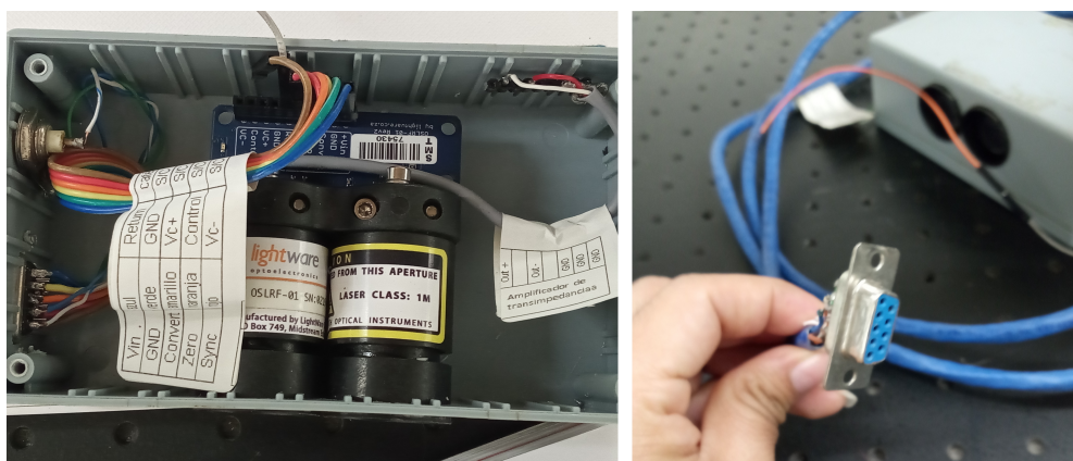
Figura 4.3: Vista de las conexiones físicas del módulo OSLRF-01.
