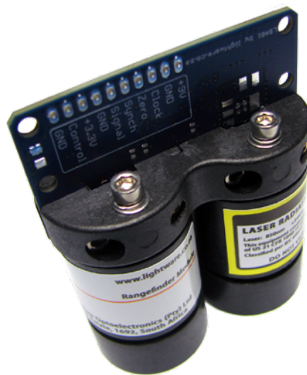
Figura 4.2: Modelo comercial, OSLRF-01.
