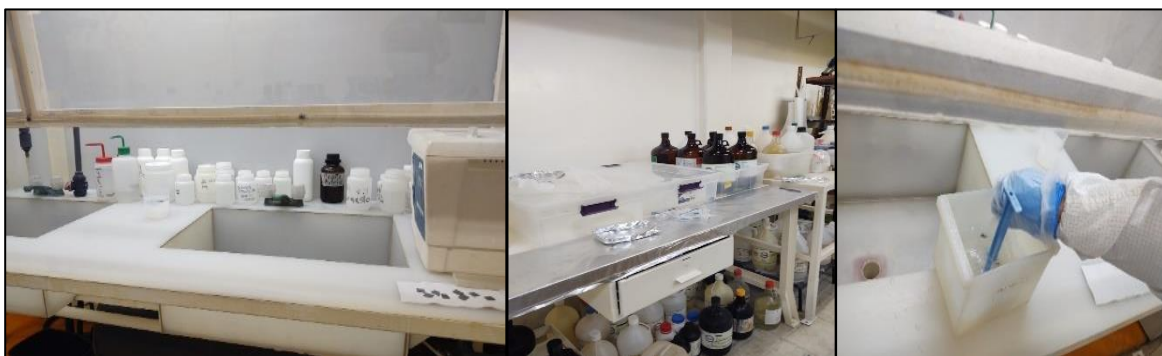
Figura 3.7.- Limpieza de muestras bajo campana y retiro de óxido nativo.
