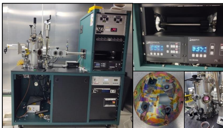
Figura 3.9.- Imagen del sistema sputtering para el depósito del ITO, donde se observa el montaje de las películas y la formación del plasma.
