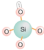
Figura 1.10.-Modelo de la estructura de un defecto tipo NBOHC.
