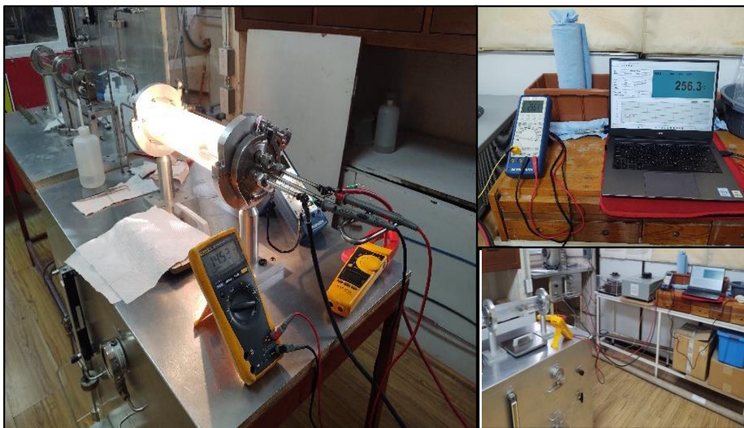
Figura 3.2.- Fotografía que ilustra el proceso de depósito de películas en el sistema HFCVD.
