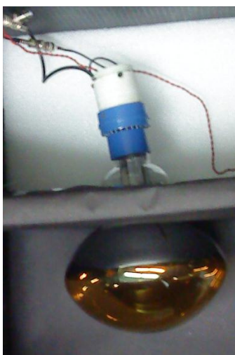
Figura 3.37: Instalación del PMT en el interior del tanque.
