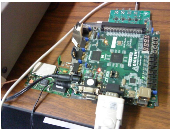
Figura 3.38: Sistema Electrónico Digital para medir la variación en la tasa de conteo, y el registro de variables atmosféricas.
