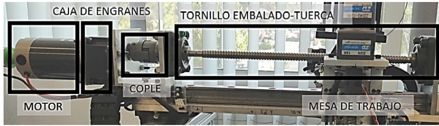
Figura 2.1: Estructura mecánica de un eje.
