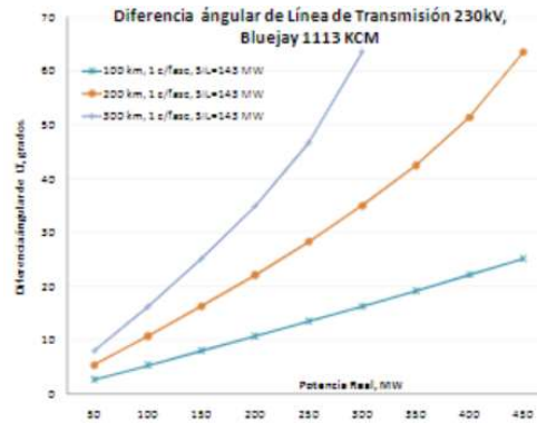
Fig. 2-4 Relación entre transmisión de potencia real y diferencia angular entre los extremos de línea de 230kV con cable ACSR 1113KCM con un conductor por fase. [18]
