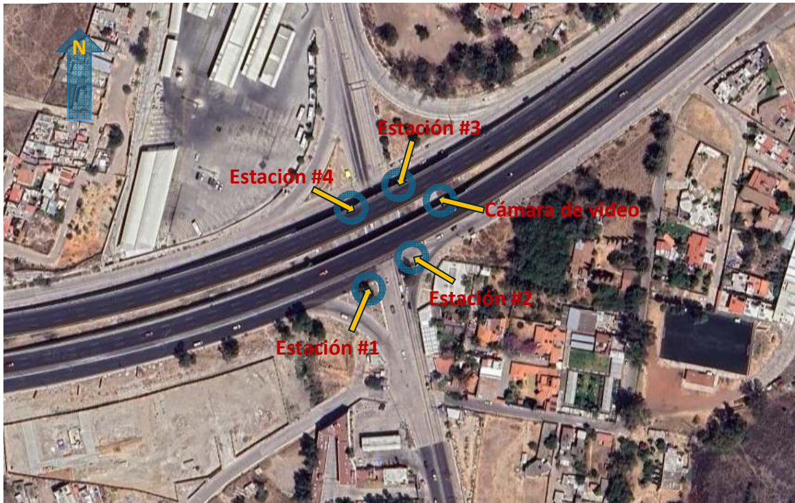
Fig. 21 Se observan las ubicaciones de las estaciones de control, para el aforo vehicular. Fuente: (google maps)
