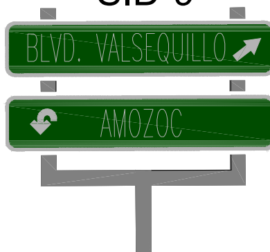
Fig. 62 Señalamiento SID-9. Fuente: (S I C T, 2023)
