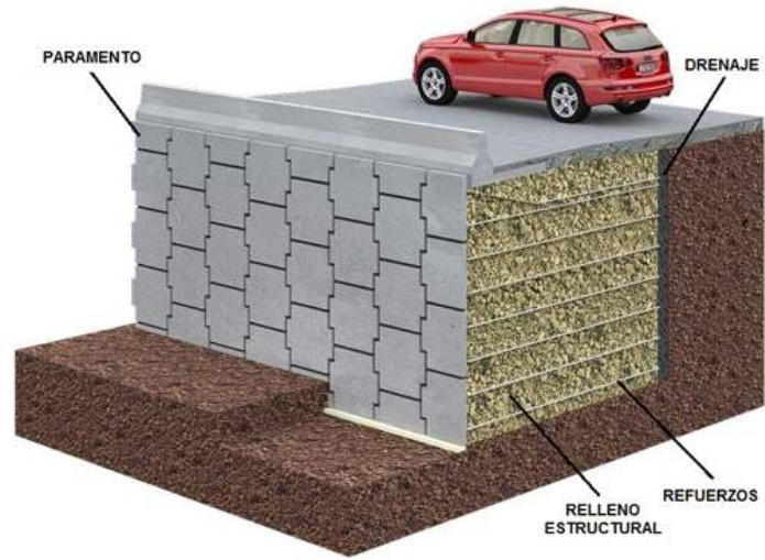
Fig. 73 Muro de Tierra Armada®, fuente: (Structuralia, 2020)
