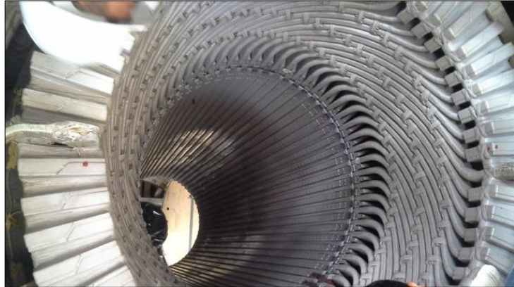
Figura 2.3 Núcleo del estátor con bobina del generador eléctrico
