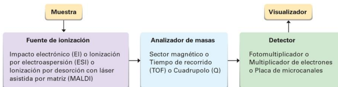
Figura 10. Esquema de análisis por espectrometría de masas 23 .
