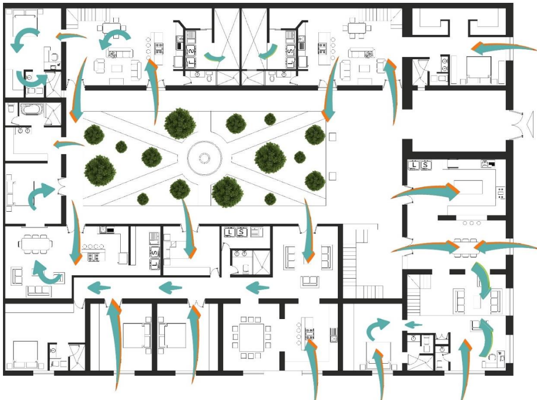
Figura 200 Sistemas de ventilación BJB|Fuente propia 2016
