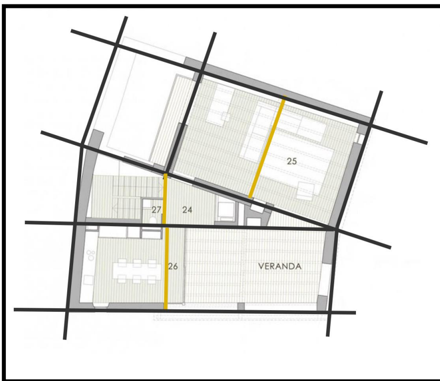
(Planos 18, 19, 20, 21, 22 y 23) Intervención de apertura por nuevos espacios indicado con líneas naranjas. Fuente: Elaboración propia
