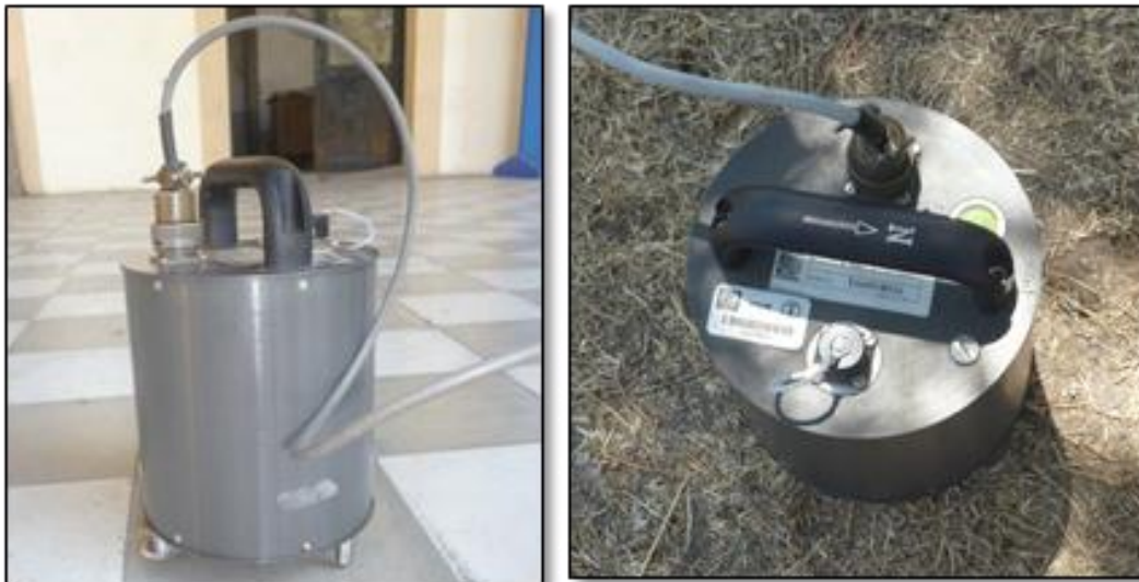
Figura 4. 3 Imagen del sensor Guralp Systems de tres componentes. Izquierda: vista lateral. Derecha: vista superior.
