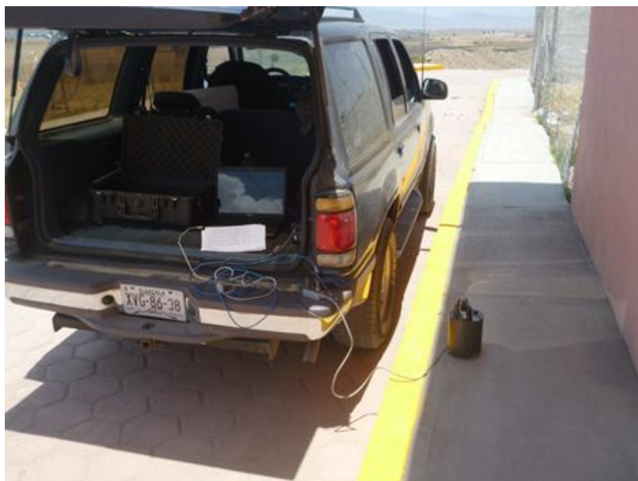
Figura 4.7 Instalación de los sismógrafos Guralp.
