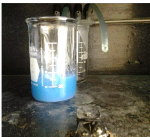
Figura 21. Muestra de azul de metileno en el interior del reactor irradiado con luz UV.
