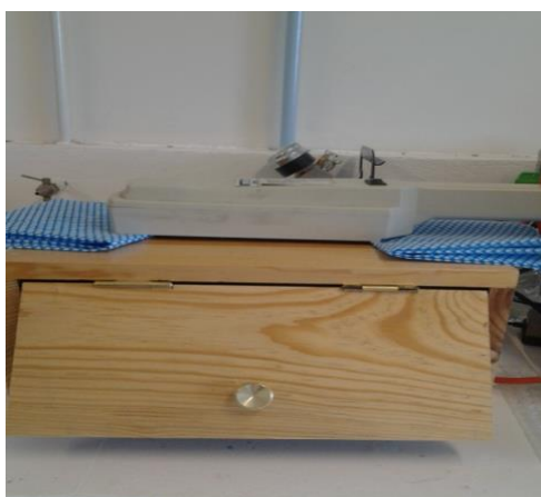
Figura 20. Fotorreactor con lámpara UV en donde se lleva a cabo la degradación.
