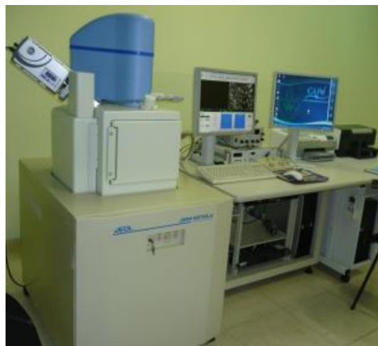
Figura 17. Microscopio electrónico de barrido utilizado para observar la morfología de la muestra.
