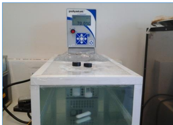
Figura 12. Síntesis de nanopartículas de plata a temperatura constante controlada por medio de un termocirculador.
