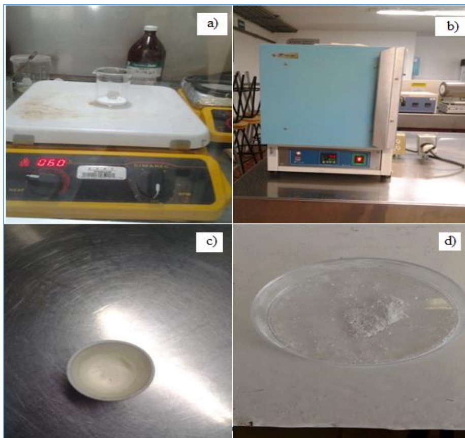
Figura 15. a) Preparación del fotocatalizador a 60°C, b) mufla a 800°C con el Ag-TiO 2 , c) y d) apariencia final del fotocatalizador.
