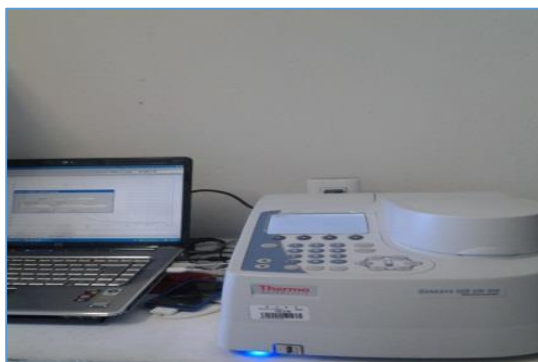
Figura 13. Espectrofotómetro de UV-Vis utilizado para la medición de las nanopartículas de plata.
