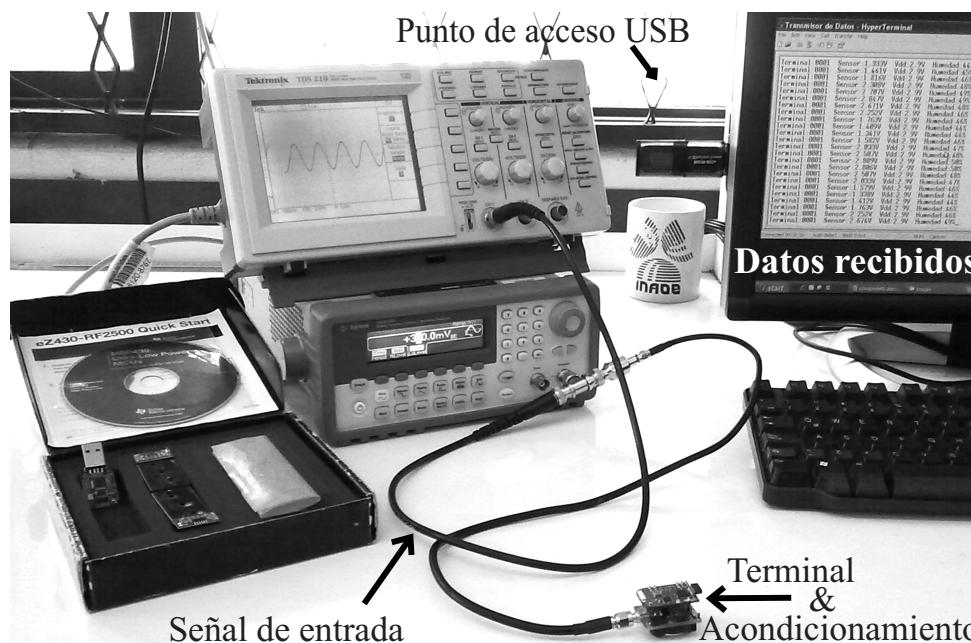
Figura 5.3: Montaje de pruebas para la adquisición y transmisión de datos
