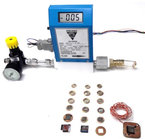
Figura 2: Setup de pruebas para la caracterización dinámica
