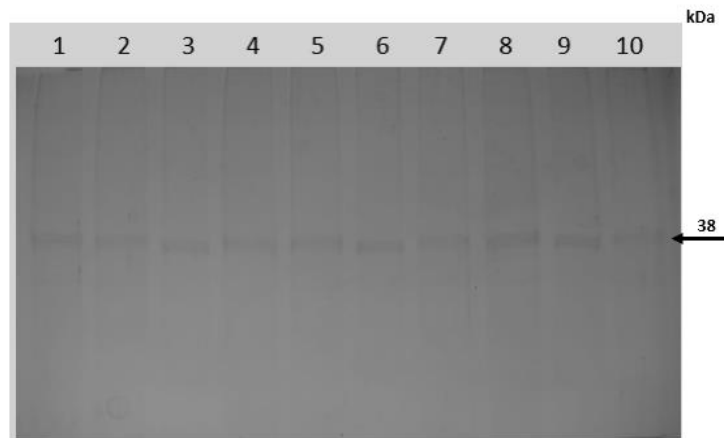
Figura 7. Electroforesis SDS-PAGE teñido con Coomassie de fracciones obtenidas mediante la purificación de FPLC de MP1 (2 µg), minuto de retención 90-109. Descripción de carriles: Carril 1: Fracción 90 y 91, Carril 2: Fracción 92 y 93, Carril 3: Fracción 94 y 95, Carril 4: Fracción 96 y 97, Carril 5: Fracción 98 y 99, Carril 6: Fracción 100 y 101, Carril 7: Fracción 102 y 103, Carril 8: Fracción 104 y 105, Carril 9: Fracción 106 y 107, Carril 10: Fracción 108 y 109.
