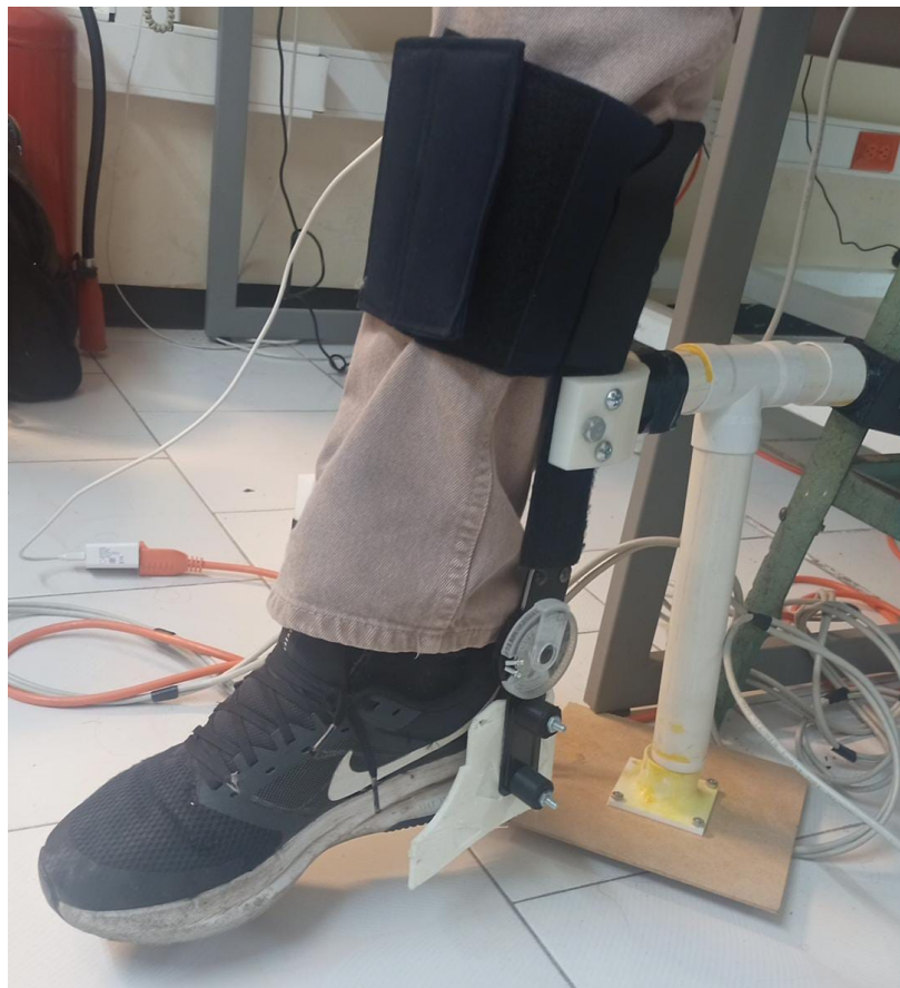
Figura 7.1: Exoesqueleto fijado a un tobillo real para realización de pruebas experimentales.
