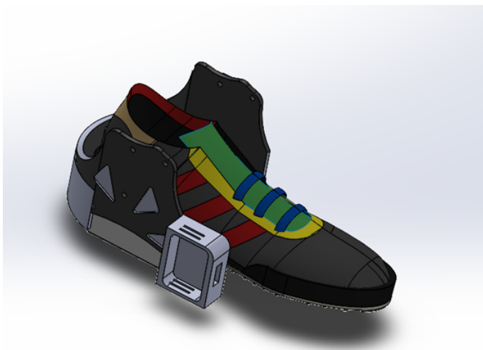
Figura 2.8: Tercer prototipo presentado que incluía un compartimiento para colocar el inclinómetro WITMOTION en la parte lateral del dispositivo.
