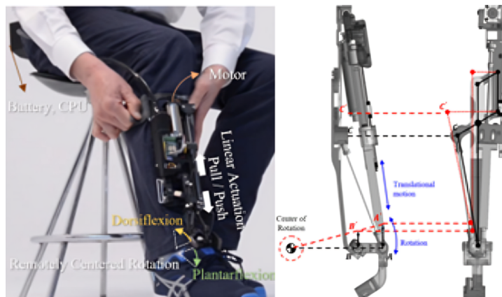
Figura 1.7: Exoesqueleto portátil de dos grados de libertad con sensores EMG y controlado por redes neuronales. Tomado de [16].
