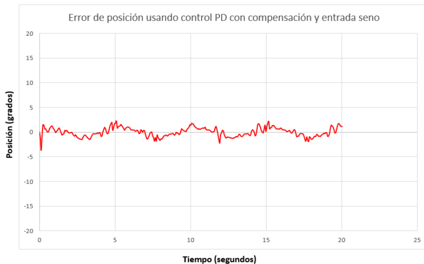
Figura 7.4: Resultados de error usando control PD con compensación.
