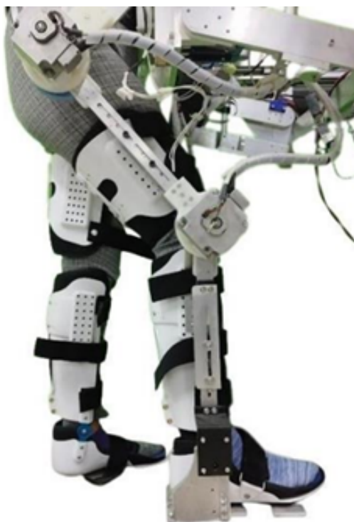
Figura 1.10: Prototipo de exoesqueleto de rehabilitación para ayudar al tobillo y la rodilla en ejercicios de lesión, propuesto por CINVESTAV. Tomado de [24].
