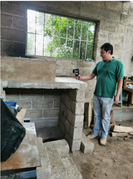
Fig. 53. Toma de temperatura de la cámara
