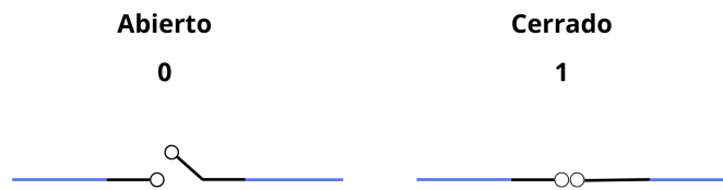
Figura 4.2: Estados del switch.
