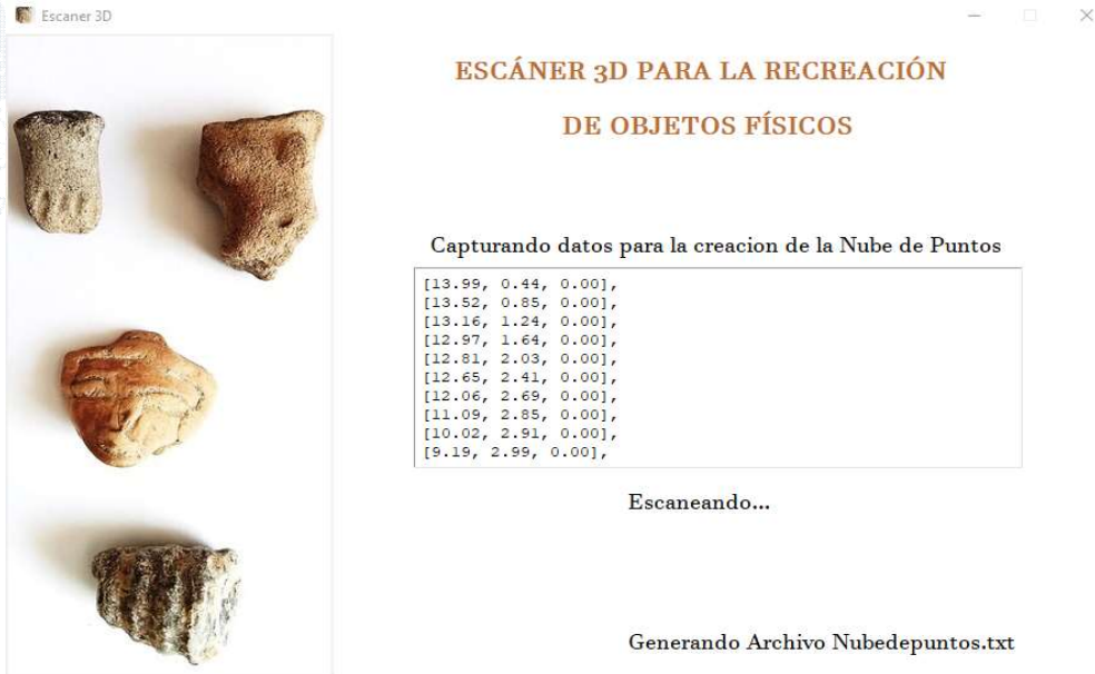
Ilustración 69 Ventana secundaria para la visualización de la captura de datos del sensor
