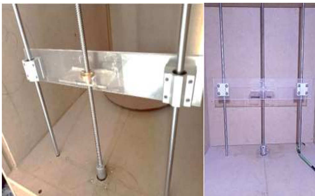
Ilustración 26 Instalación de la base del sensor. Elaboración propia.
