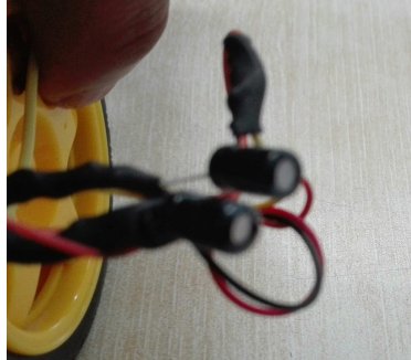
Figure 19: Capacitores soldados a un sensor
