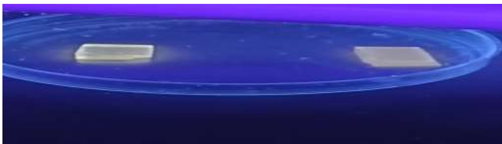
Figura 2.3. Película de Qd's de ZnO con lámpara UV
