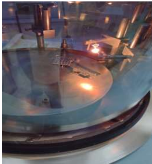
Figura 2.8. Depósito de los contactos de Plata por evaporación térmica
