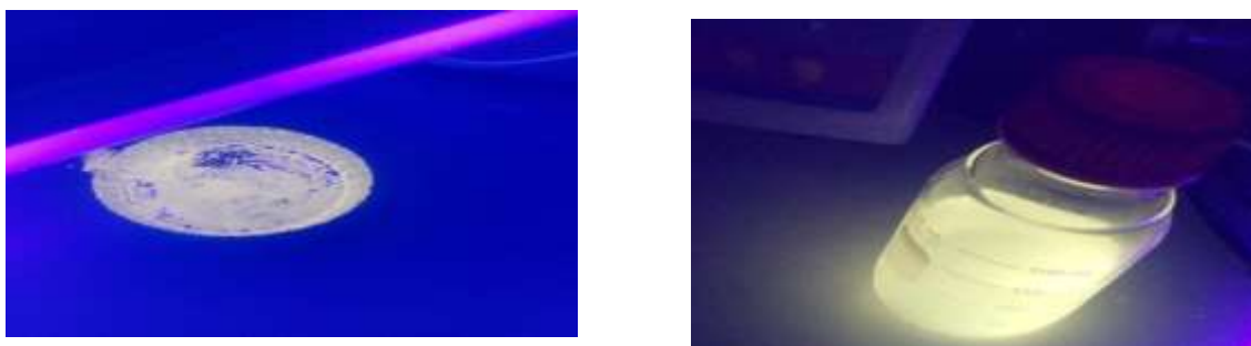
Figura 2.2. Efecto de luminiscencia con lámpara de UV sobre QD's de ZnO en polvos y solución.
