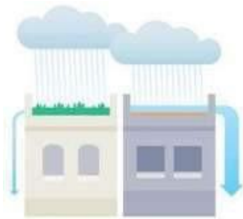
Fig. 68 Captación de agua pluvial con cubiertas verdes BCN, 2015
