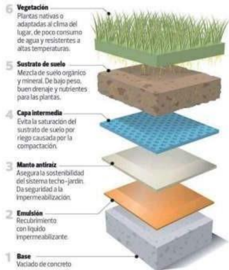
Fig. 44 Elementos de una cubierta verde Bianchini & Hewage, 2012; Garcia, 2010
