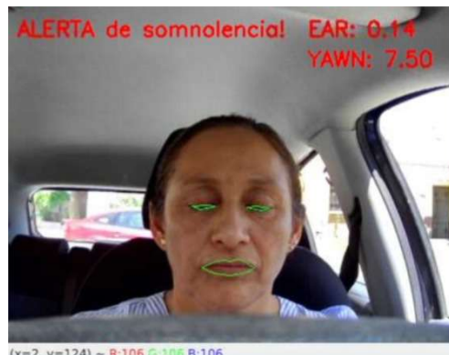
(b) Leyenda: “ALERTA de somnolencia!” en el cuadro de imagen cuando se detecta somnolencia.
