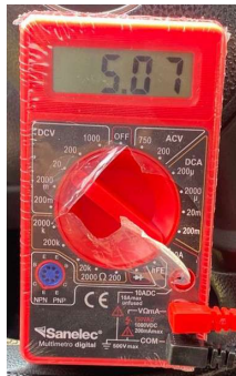
(c) Voltaje en pines 2 y 6 usando fuente oficial raspberrypi .
