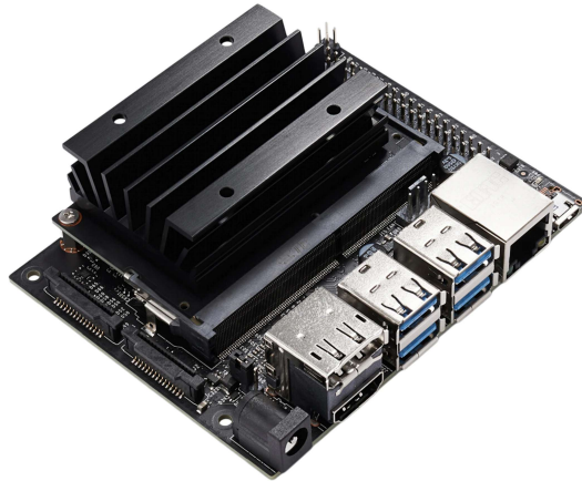
Figura 2.4: Placa de desarrollo Nvidia Jetson nano .
