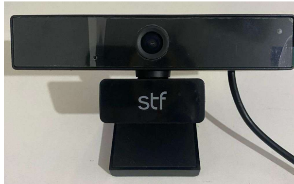
Figura 3.3: Sensor: cámara web Full HD a 30 cuadros por segundo.
