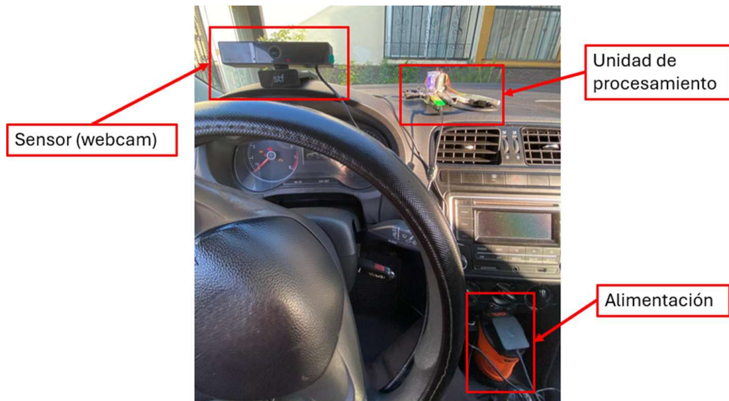
Figura 4.1: Integración del prototipo del Sistema de Detección y Alertamiento de Somnolencia en un automóvil.
