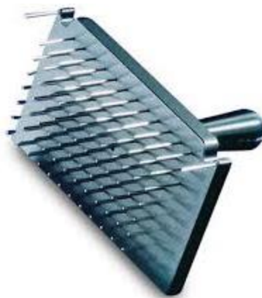
Figura 22. Replicador de 96 dientes (Recuperado de: https://www.boekelsci.com/microplate-replicators.html ).
