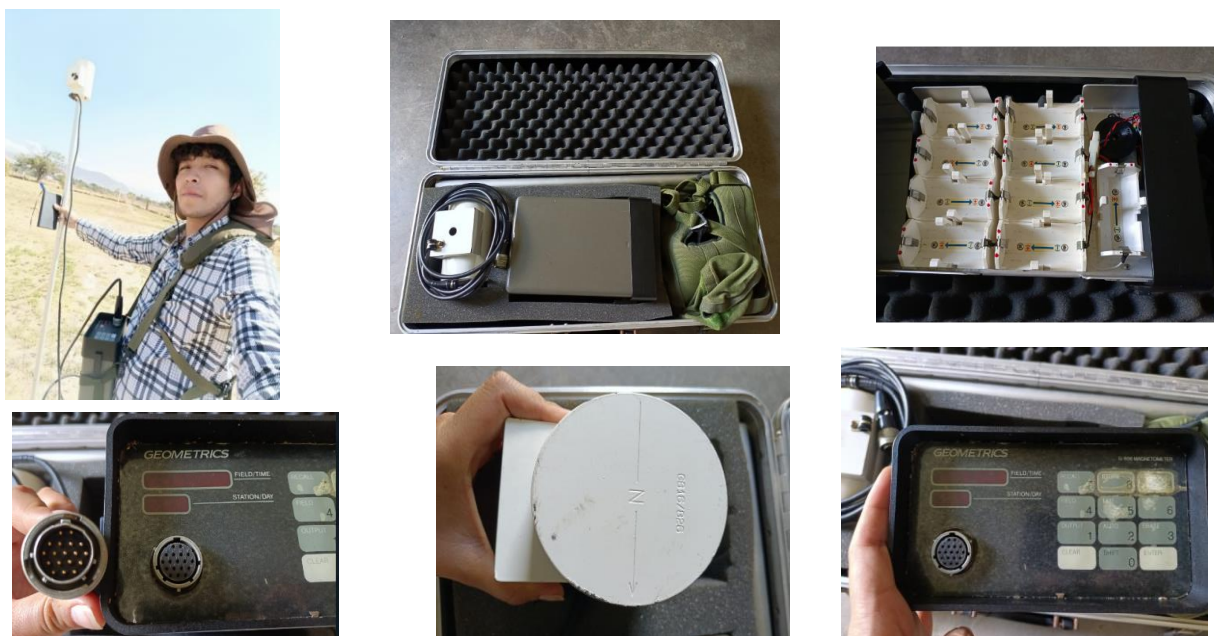
Ilustración 19. Equipo de magnetómetro protónico terrestre de Geometrics G-856 proporcionado por el IPN CIIDIR Oaxaca, utilizado para las lecturas en campo de este trabajo. 2023.
