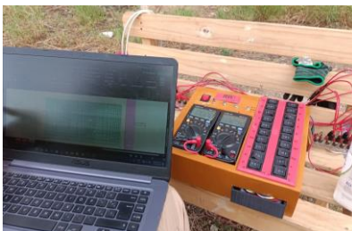
Ilustración 20. Equipo de prospección eléctrica ensamblado y proporcionado por el IPN CIIDIR Oaxaca, utilizado para las lecturas en campo de este trabajo. 2023.
