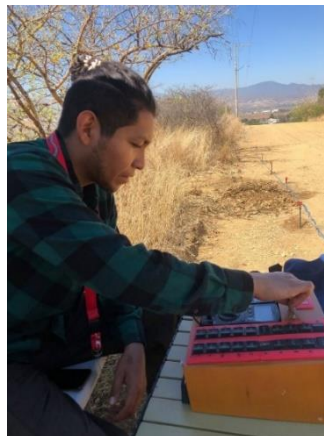
Ilustración 20. Equipo de prospección eléctrica ensamblado y proporcionado por el IPN CIIDIR Oaxaca, utilizado para las lecturas en campo de este trabajo. 2023.
