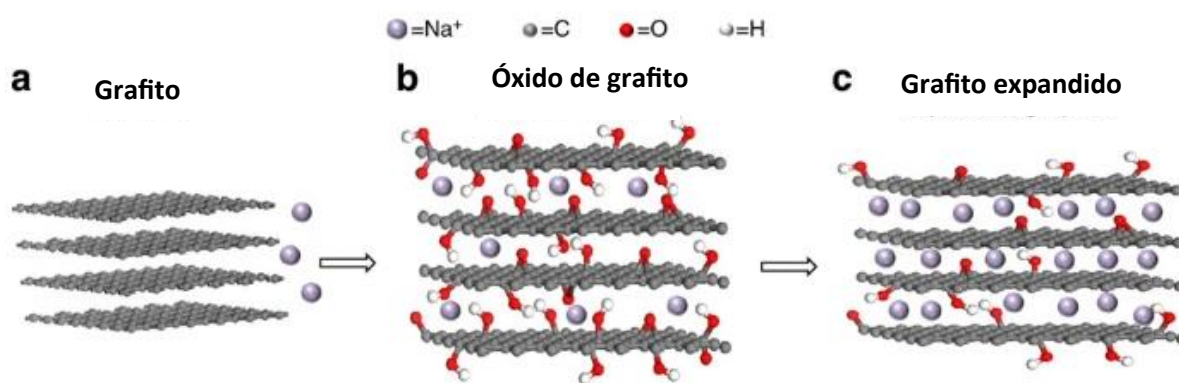
Figura 1.1 Almacenamiento de Na en materiales a base de Gr [5]
