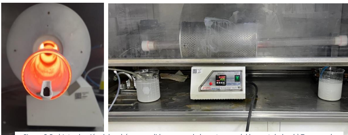
Figura 3.5 a) Introducción del carbón expandido por uno de los extremos del horno tubular, b) Trampas de agua para expansión del carbón
