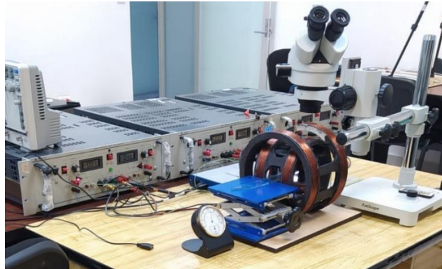
Figura 4. Arreglo experimental de campos magnéticos oscilantes.
