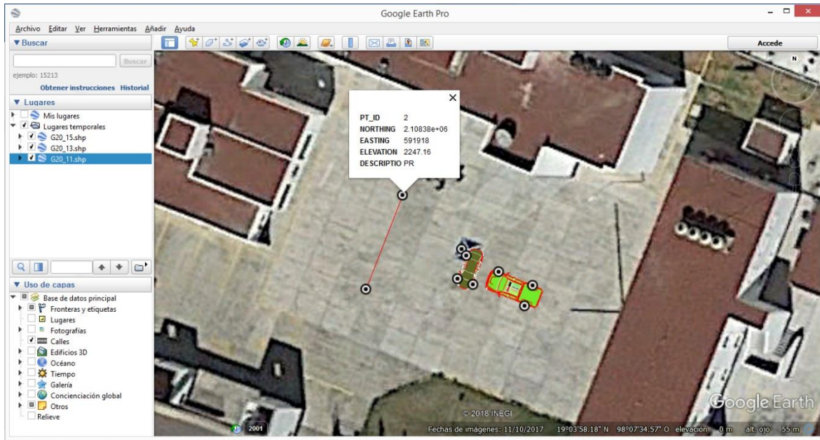
Figura 6.9 Abriendo archivo SHP generado por el colector de datos T41, con el software de campo CSI Mobile.
