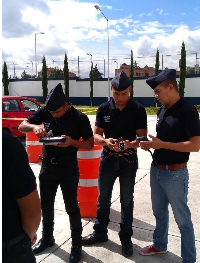
Figura 5.6 Detalle de instalación de baterías en receptor GNSS SP80 Spectra Precision en el sitio.
