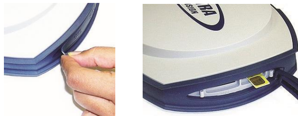
Figura 5.8 Instalación de tarjeta SIM en el receptor GNSS SP80.
