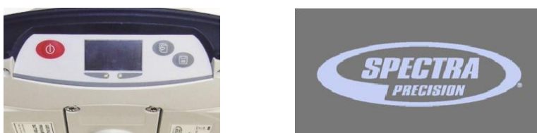
Figura 5.9 Encendido del receptor GNSS SP80.
