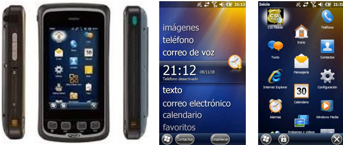
Figura 5.10 Encendido del colector de campo T41 he inicialización de software de campo CSI Mobile de la marca Carlson Software.
