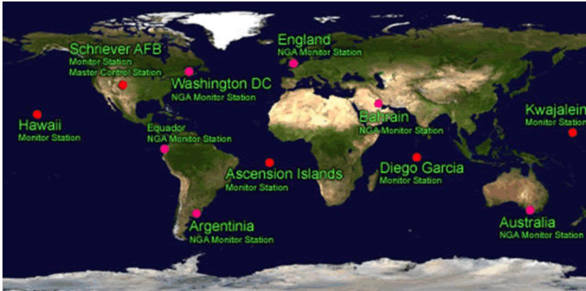
Figura 4.2 Posición de las estaciones de seguimiento y la estación principal de control.
