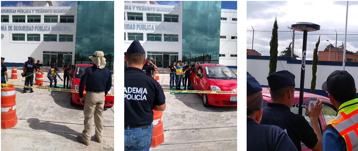
Figura 5.19 Secuencia de proceso de posicionamiento del equipo GNSS para la medición de uno de los vértices del vehículo.
