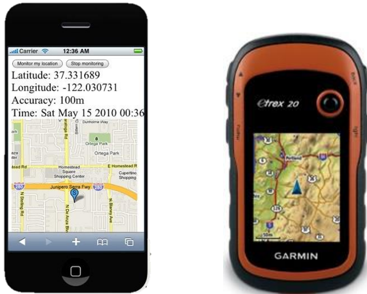
Figura 3.24 Lado izquierdo imagen de un Smartphone con aplicación GPS y del lado derecho un equipo GPS navegador de la marca Garmin con precisión de \pm 3m .
