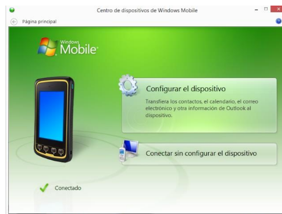
Figura 6.4 Conexión de Colector de campo T41 como dispositivo de Windows Mobile.
