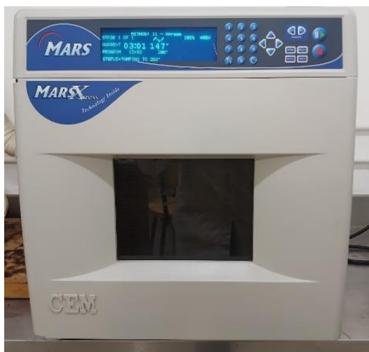
Figura 33. Digestión de la muestra
