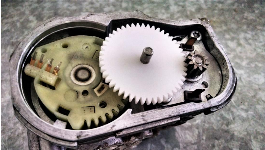
Figura 2.10 Arreglo de engranes del ETB.
