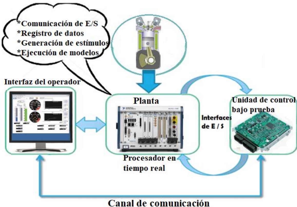
Figura 3.3 Componentes del sistema Hardware in the Loop.
