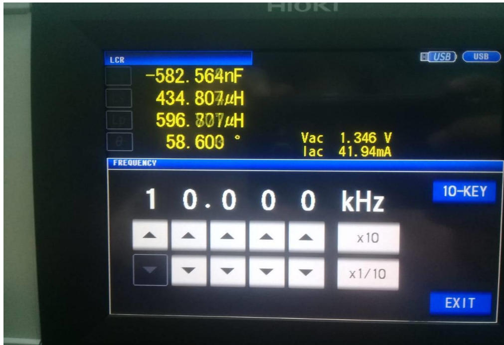
Figura A.2 Lectura de la Inductancia del Motor de CC del ETB.
