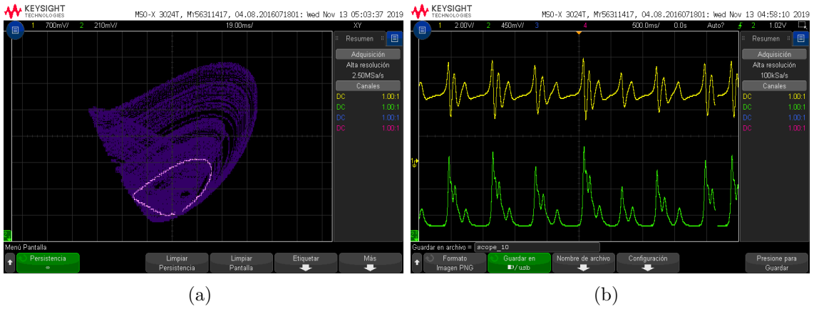
Figura 4.5: Implementación del sistema con puntos de equilibrio estable (3.1) en Raspberry, (a) atractor caótico fase x - y , (b) series de tiempo (ecuación x en amarillo, ecuación y en verde).
