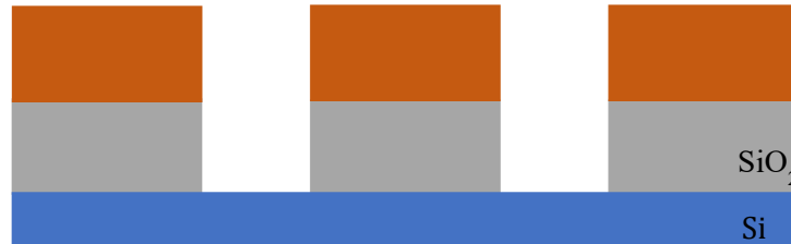
Figura 18. Grabado anisotrópico, con grabado final en una sola dirección
