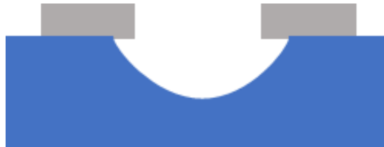
Figura 19. Esquema representativo de un micromaquinado de volumen.
