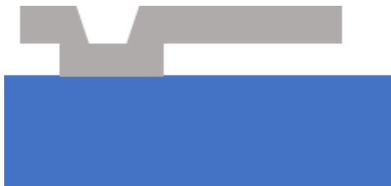
Figura 20. Esquema representativo de un micromaquinado de superficie
