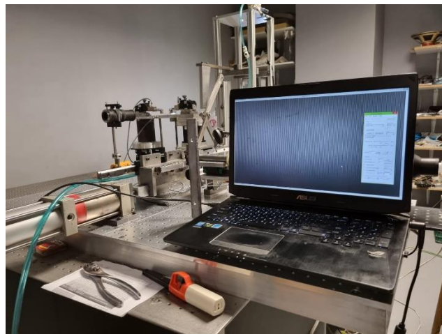
Figura 4.15. Rejilla enfocada vista en el programa LuCam Capture .
