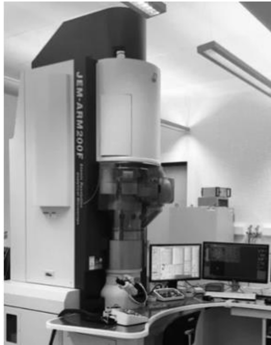
Figura 25 Corresponde a un Microscopio electrónico de transmisión modelo JEOL JEM-ARM200CF.
