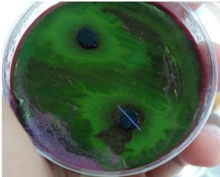
Figura 48 Pruebas de difusión en agar del recubrimiento de WO x ; E. coli, 72 hrs. Y con 1.2 cm de inhibición.
