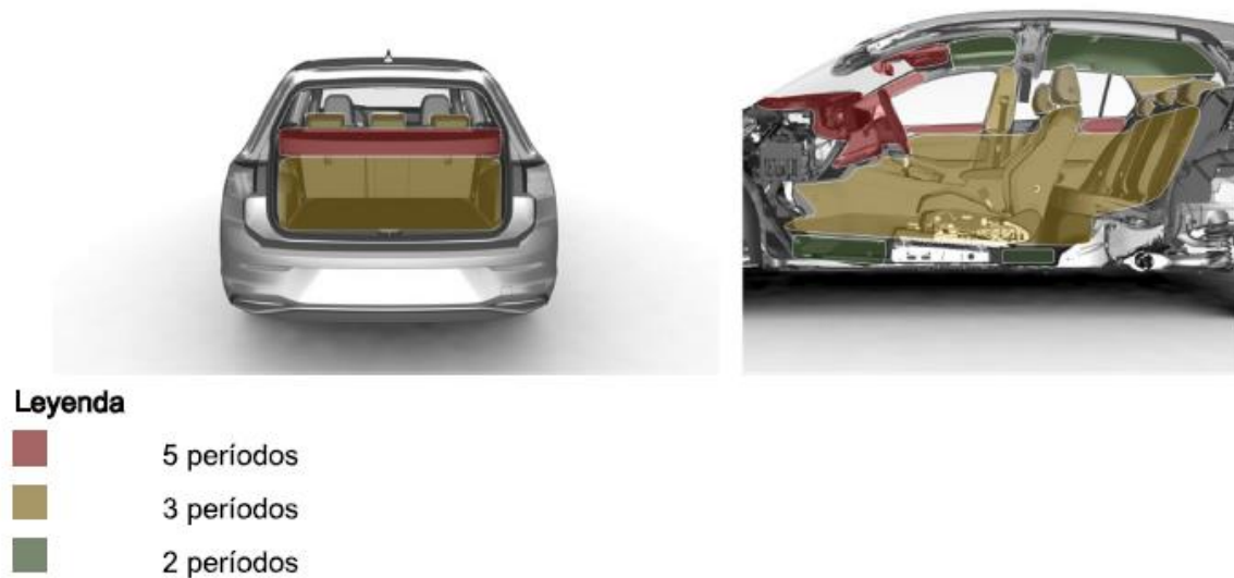
Figura 20 Simulación de zonas (carga térmica) en forma de periodos de exposición UV [96].
